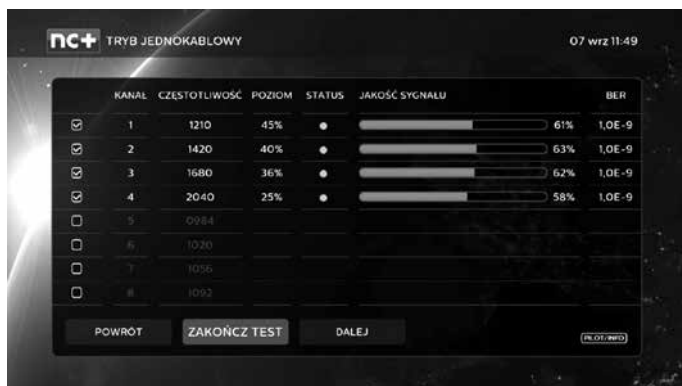
Parametry sygnału dla poszczególnych kanałów urządzenia UNICABLE
